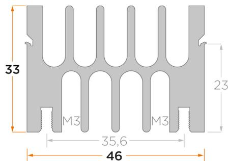
Standard-Profilkühlkörper für Clip-Montage mit den Clip-Typen: MC725, MC 726, MC 773, MC 797
