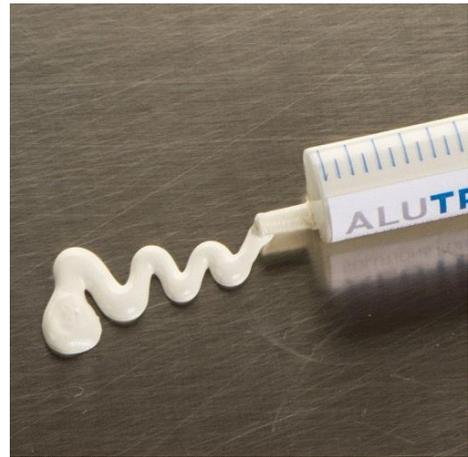
Wärmeleitpaste füllt schlecht wärmeleitende Lufteinschlüsse und sichert bestmöglichen Wärmeübergang. Für eine Fläche von 100x100 mm (unbearbeitetes Strangpressprofil) wird in etwa 0,4g Wärmeleitpaste benötigt, diese sollte als dünner Film aufgetragen werden.
