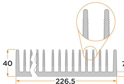
Standard-Profilkühlkörper für Schraubmontage
