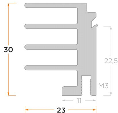
Standard-Profilkühlkörper für Clip-Montage mit den Clip-Typen: MC725, MC 726, MC 773, MC 797
