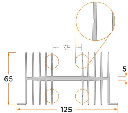
Standard-Profilkühlkörper mit versenkter Montagefläche
