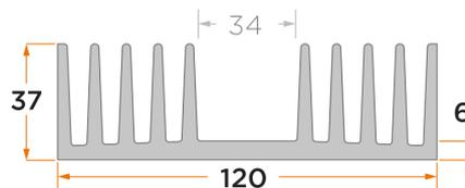
Standard-Profilkühlkörper mit versenkter Montagefläche
