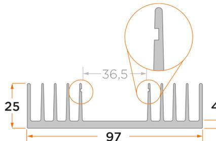
Standard-Profilkühlkörper mit versenkter Montagefläche
