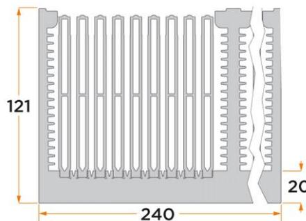
Standard-Profilkühlkörper einseitig verrippt (Kammprofil) mit eingepressten Hohlrippen für Frembelüftung
