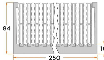
Standard-Profilkühlkörper einseitig verrippt (Kammprofil) mit eingepressten Hohlrippen für Frembelüftung
