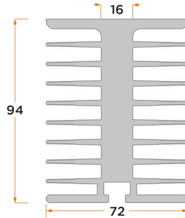
Standard-Profilkühlkörper mit Montagefläche
